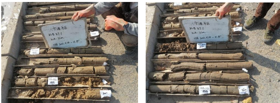
照片 1-4、1-5 工程地质钻孔（ZT1）岩芯
