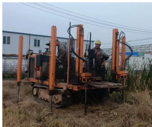
照片 1-2、1-3 工程地质静探施工（JT1、JT2）
