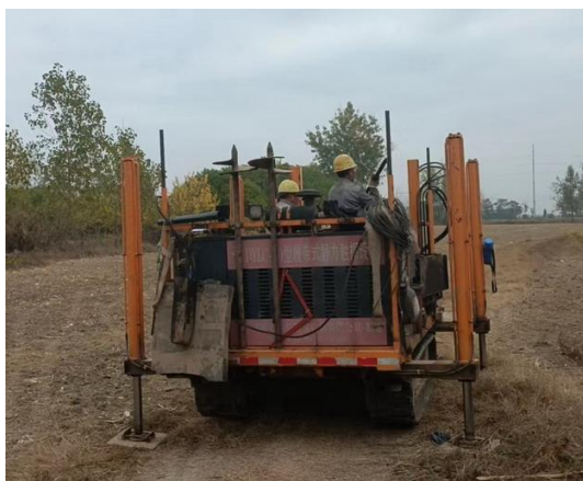
照片 1-2、1-3 工程地质静探施工（JT1、JT2）
