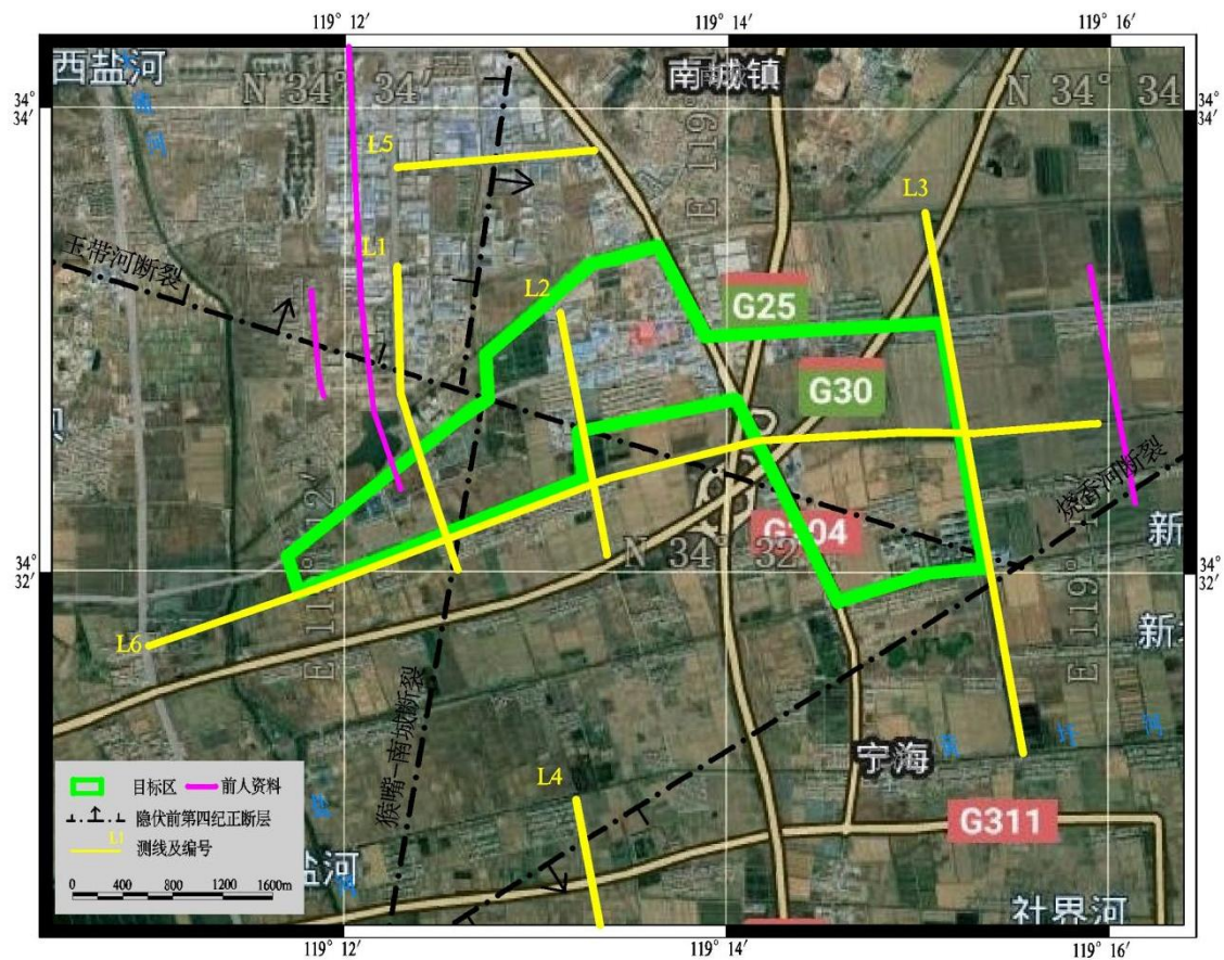
图 4.2-1 浅层人工地震探测测线布置示意图
