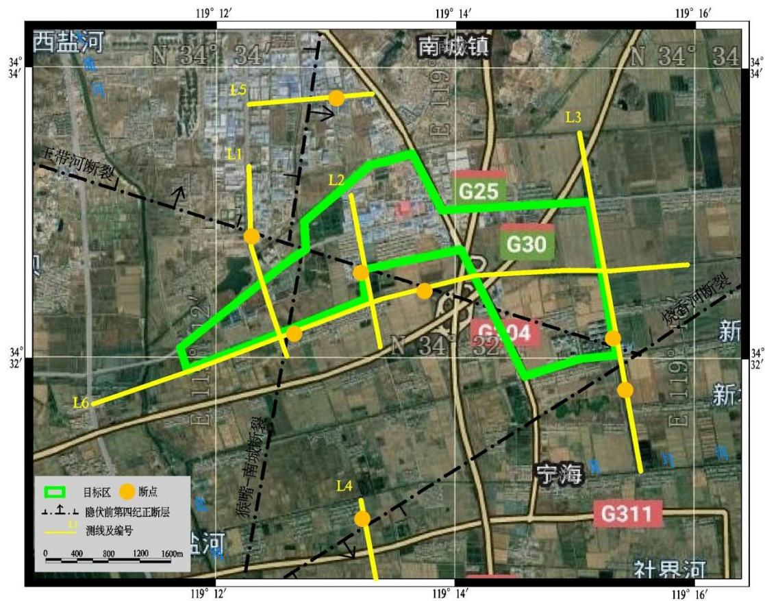
图 5-2 测线所在位置断裂断点位置图
