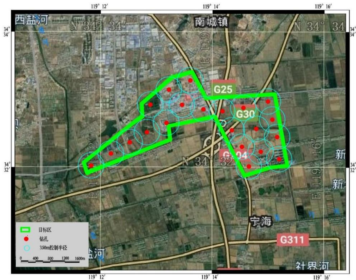
图 5.1-3 连云港高新技术产业开发区区域性地震安全性评价钻孔覆盖图（350 m 半径控制）
