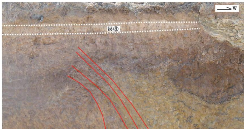
图 2.4-18 探槽南壁局部，层⑧未被断层所断错（张鹏等，2019）
