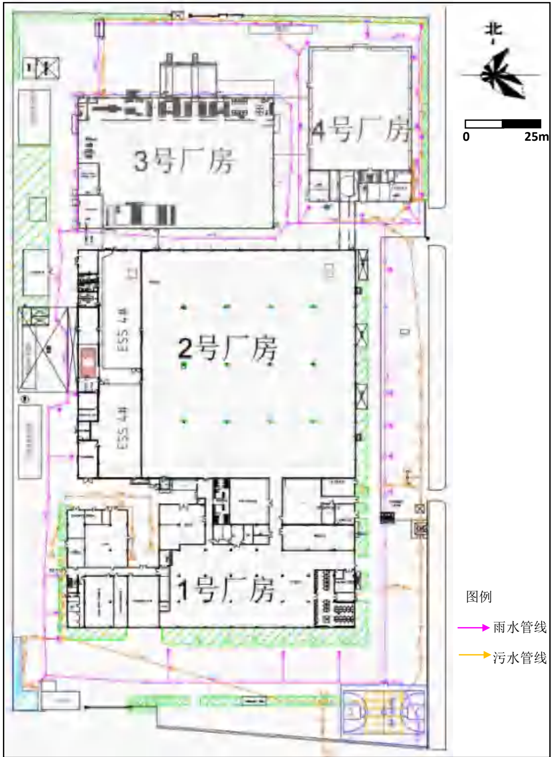
附图六 厂区雨污水管线图
