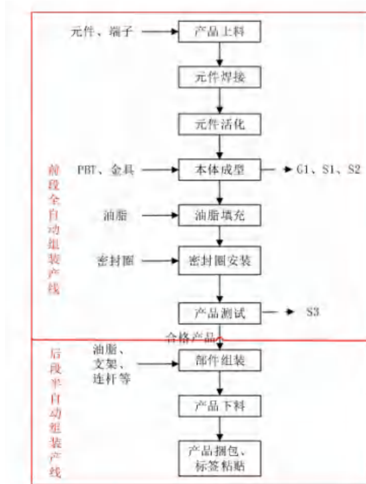
图 2-12 CPS2.1 传感器生产工艺流程及产污环节图
