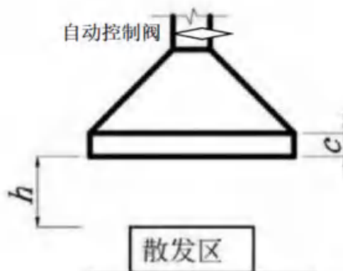
图 4-2 集气罩示意图
